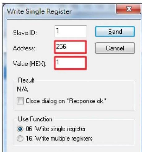
Рисунок 5.31. Очистка статистики по портам коммутатора с помощью утилиты Modbus.
