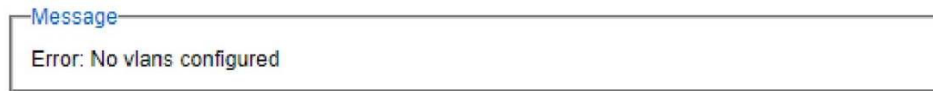
Рисунок 11.10. Сообщение об ошибке: для функции MLD не настроена ни одна виртуальная сеть.
